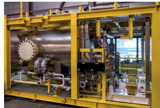
Separador CPI montados sobre patines
