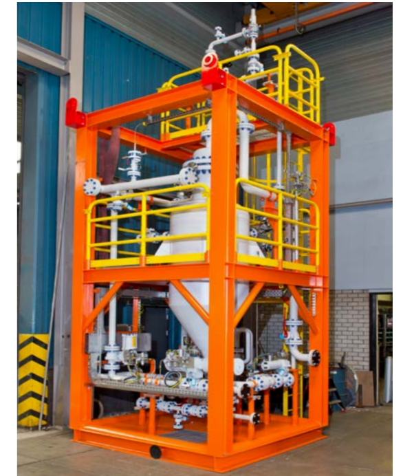
Limpieza de arena sobre patines
