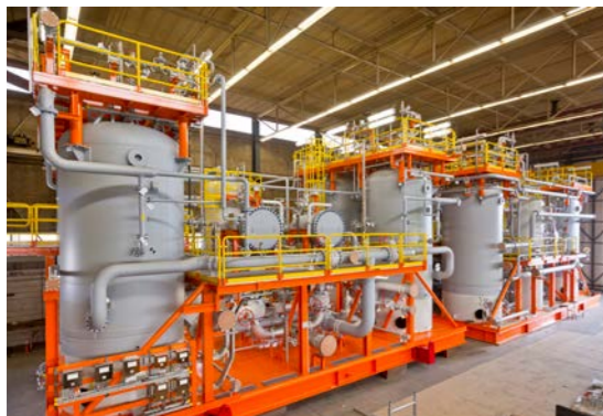
Tratamiento de agua producida sobre patines
